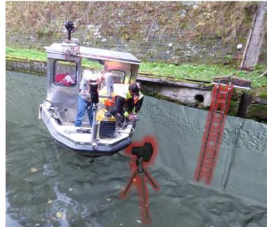
Reconstruction 3D d'une entrée de tunnel navigable à partir de données laser (TLS) et sonar (Sondeur multi-faisceau)
