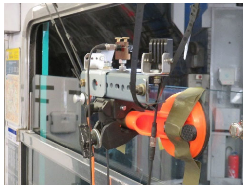
Caméra et capteur laser
