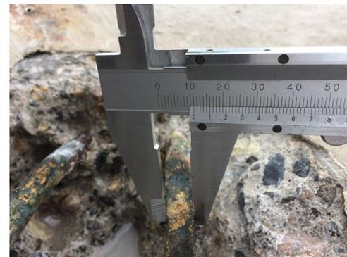
Aucune méthode non destructive ne permet de mesurer de façon fiable les pertes de diamètre des armatures corrodées; quid de l'évaluation des piqûres?
