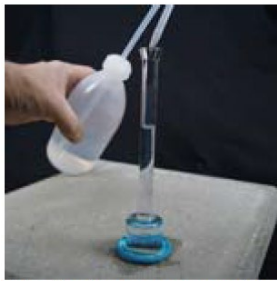
Tube Karstens avec une chambre Sources : www.tqc.eu
