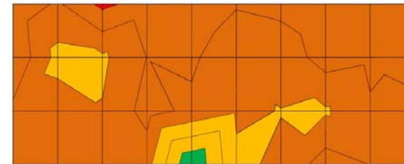
Figure 2 : Cartographie des potentiels de la zone 1 en mV versus Cu/CuSO 4
