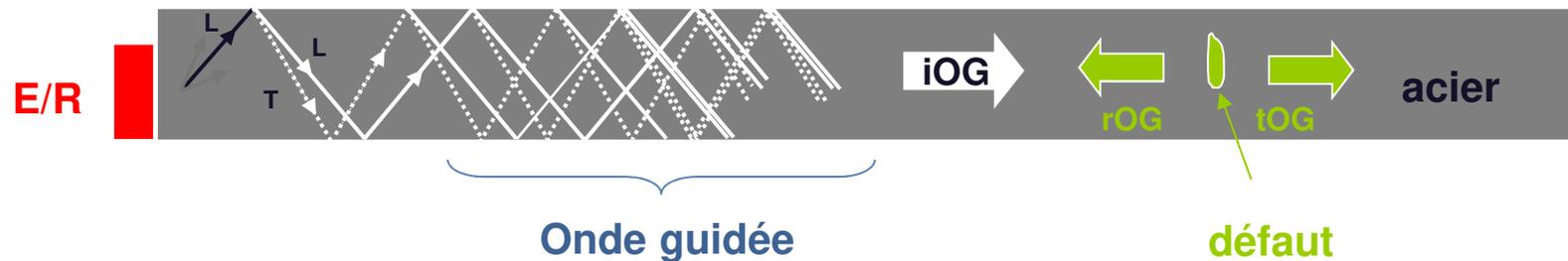
L'onde de volume excitée, interagit multiples fois avec les parois latérales de l'élément à ausculter pour donner lieu à un régime particulier de vibration dans la section transverse se propageant dans la direction longitudinale (*modes transverses propagatifs dans la direction longitudinale, ayant des vitesses de propagation dépendantes de la fréquence*)
