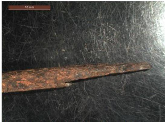
Figure 14 : Rupture ancienne sans striction avec une propagation longitudinale importante et un cisaillement final à environ 45°.
