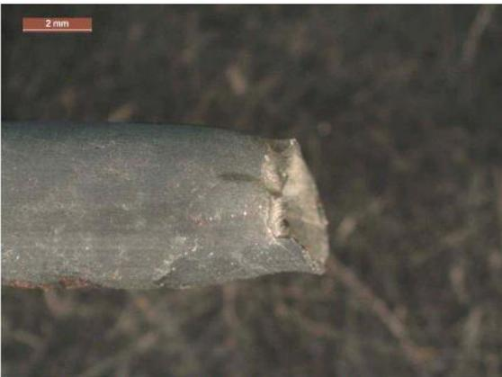
Figure 17 : Rupture ductile par surcharge (type cup and cone).
