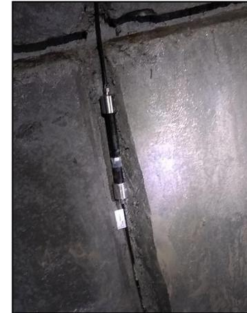
Détail d'un capteur Bragg
