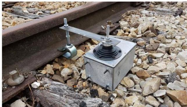
**Fig 3 : Vue d'une maquette fonctionnelle d'un boîtier Lynx-Boogie**
