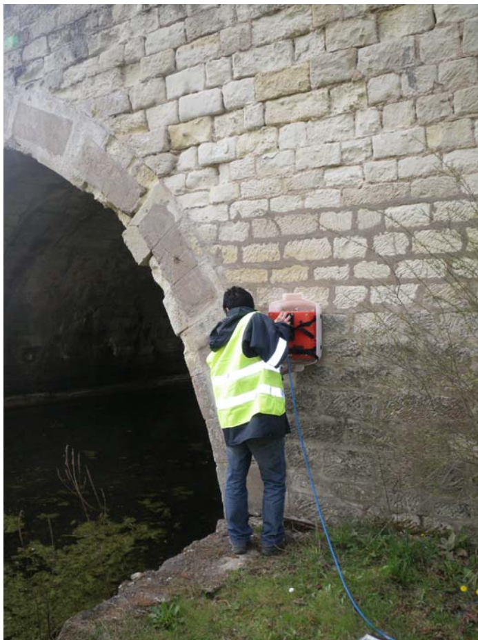
Reconnaissances structurelles : reins et clef de voûte, auscultation RADAR
