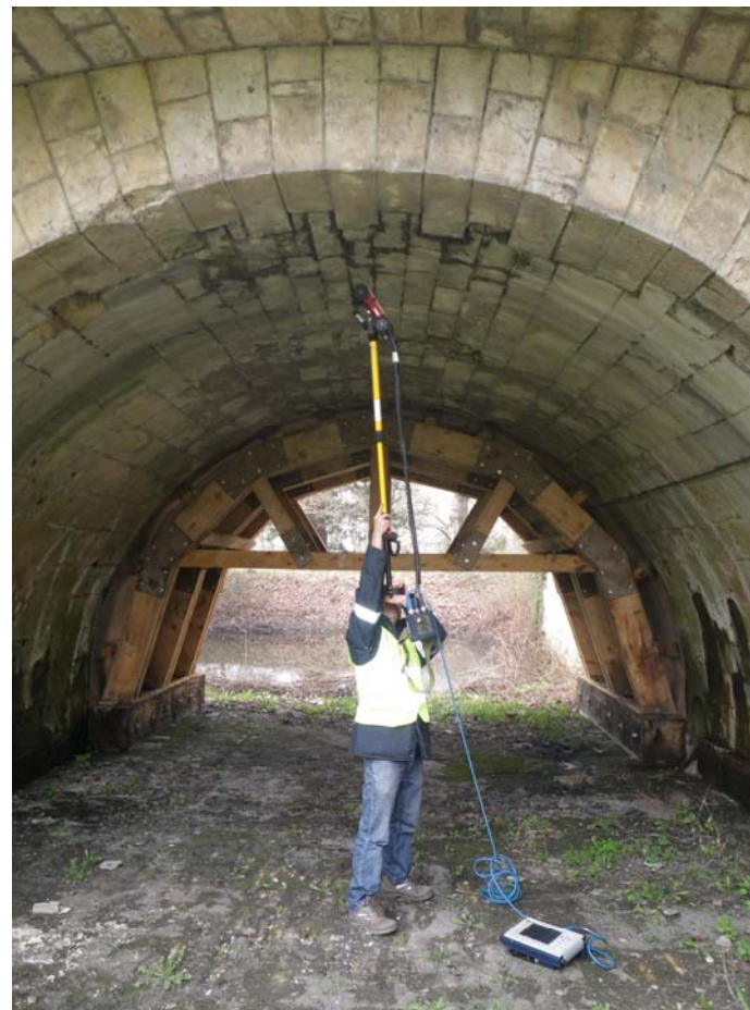
Reconnaissances structurelles : reins et clef de voûte, auscultation RADAR
