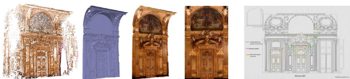
➤ Figure 18 : Nuage de points, maillage 3D, modèle texturé, orthophotographie et plan
