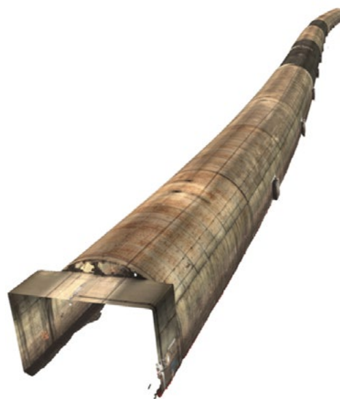
► Figure 39 : Reconstruction 3D de la voûte d'un tunnel
