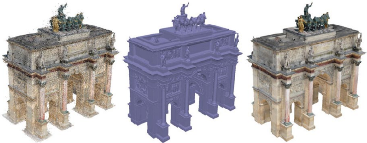
► Figure 28 : Nuage de points, maillage 3D, maillage 3D texturé
