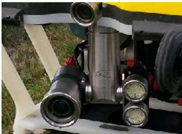
► Figure 11 : Tourelle vidéo optique, avec éclairage
