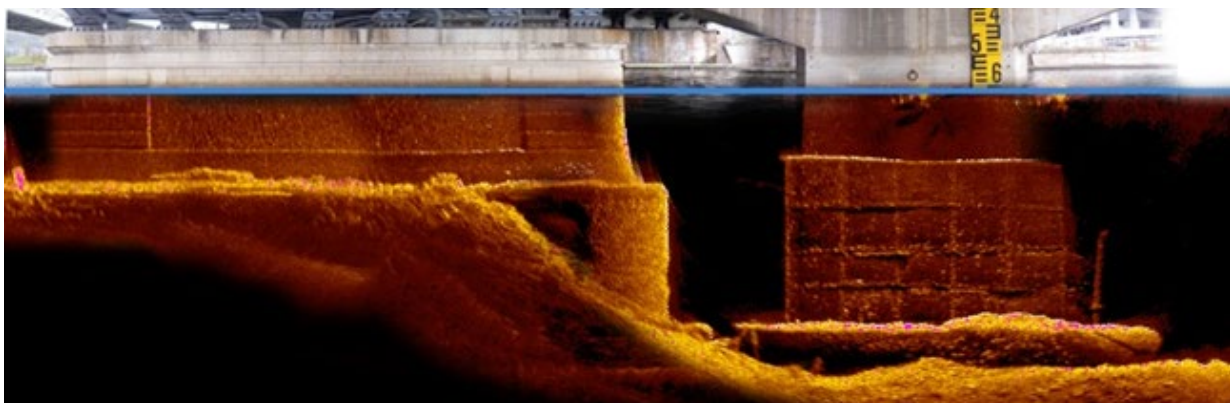
► Figure 13 : Appuis immergés par SONAR à balayage
